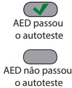
6. Verifique que o sinal verde (✓) aparece na janela do indicador de estado e que o desfibrilador não emite nenhum bipe. Isto indica que a nova bateria e os elétrodos de desfibrilação foram instalados corretamente e que o desfibrilador ZOLL AED 3 está pronto a ser usado.
