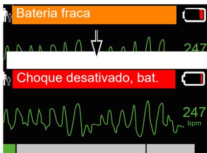
Fig. 3.2 Indicação de bateria sem carga
