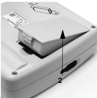
→ Se utilizar a bateria recarregável de Li-Ion, prima o botão para ativar o teste de capacidade da bateria. Todos os 4 LED acendem quando a capacidade da bateria está entre 75 e 100%. Para obter detalhes sobre o estado de carregamento, consulte [6.1.2 Indicador de estado com LED da bateria recarregável de iões de lítio](#), página 51.
